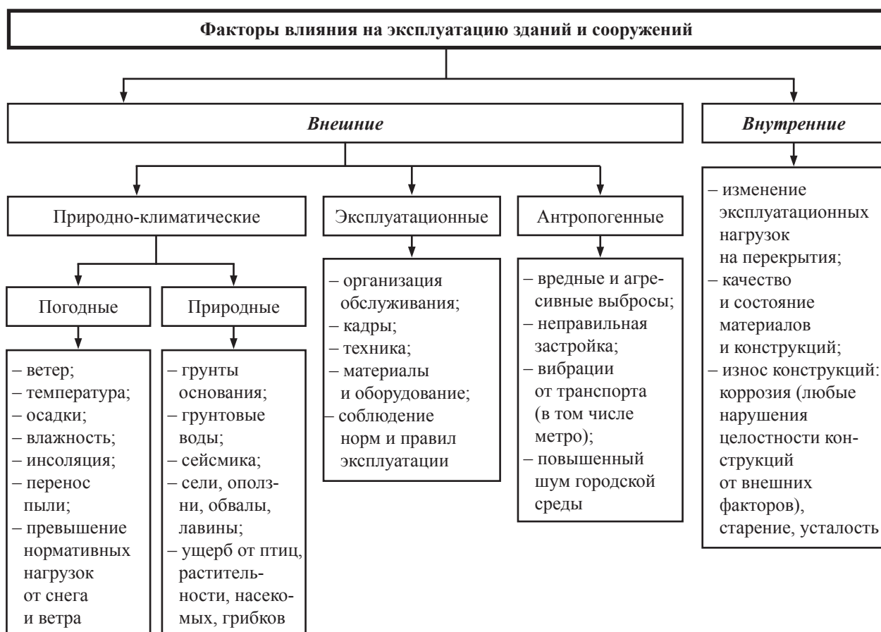
Рисунок 5. Факторы влияния на эксплуатацию зданий и сооружений
