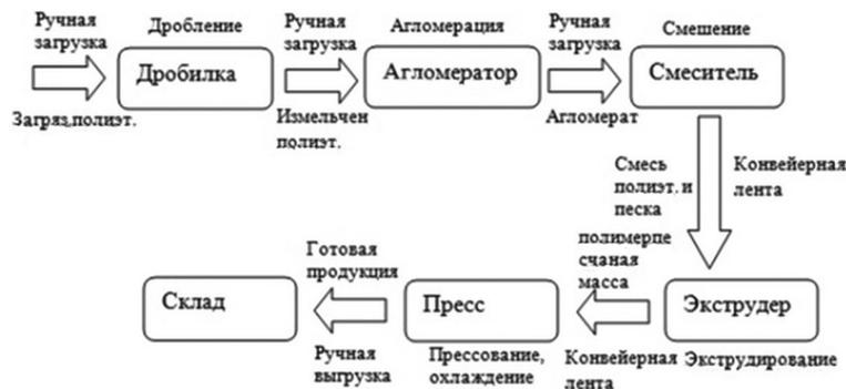
Рисунок 1. Линия переработки полимерной пленки в полимерпесчаные изделия
