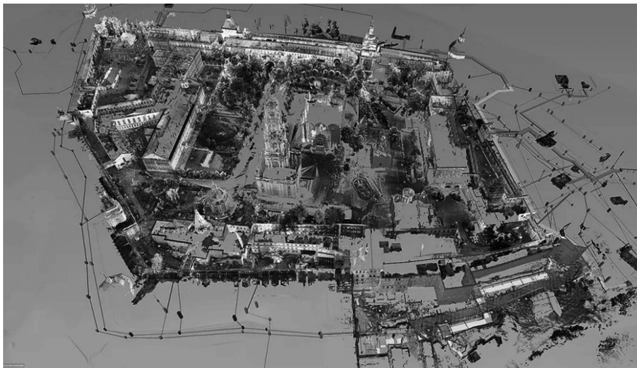
Рисунок 4. Результат наложения лазерного сканирования на трехмерную модель территории
