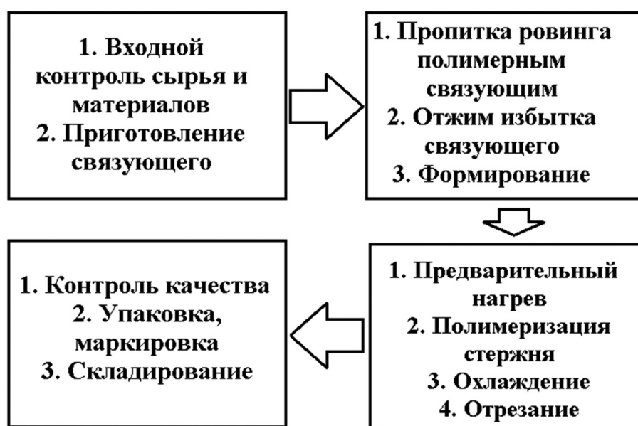
Рисунок 2. Изготовление композитной полимерной арматуры
