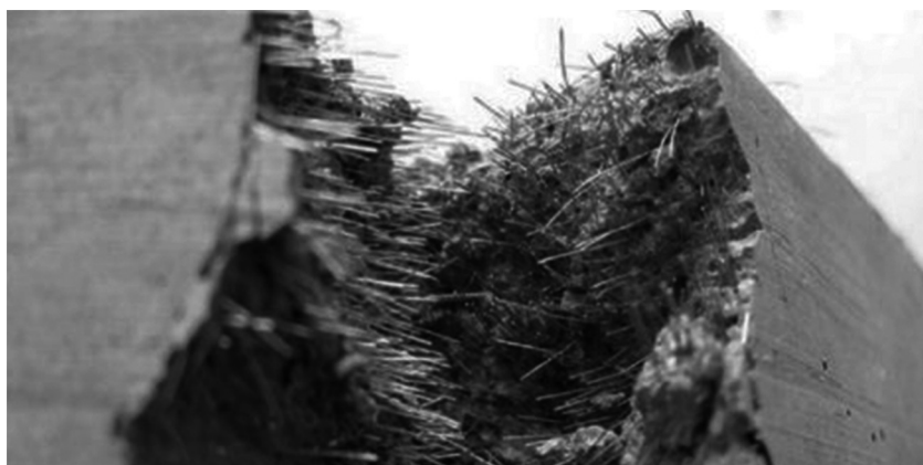
Рисунок 4. Разлом фиброармированного камня
